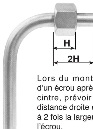
Lors du montage d'un écrou après un cintre, prévoir une distance droite égale à 2 fois la largeur de l'écrou.
