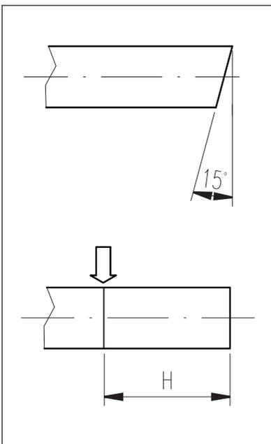
Le tube doit être coupé à angle droit avec une tolérance maximale de 15°. L'assemblage correct se réalise seulement avec l'insertion du tube jusqu'à la feuillure dans le siège du raccord. Afin d'avoir la certitude absolue que cette condition se réalise, il est conseillé de marquer graphiquement la profondeur d'accouplement du tube (cote H).
