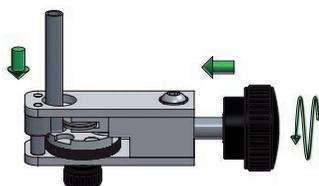
**Phase 3.** Insérer le tuyau dans le trou jusqu'au fond; visser le bouton tournant (1) afin que la lame soit contre le tuyau et continuer à serrer pour rainurer la surface du tuyau.
