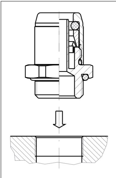
L'étanchéité des raccords droits se réfère à ce qui a été établi par la norme ISO 6149 DIN 3482. Pour obtenir un assemblage correct des raccords droits, il est nécessaire de se conformer rigoureusement aux valeurs de serrage indiquées dans la table suivante.
