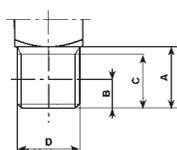
N°2 : filetage cylindrique BSP avec téton
