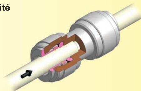
Insérer le tube entièrement dans le raccord jusqu'à la butée
