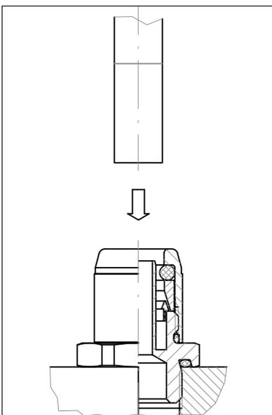
Le montage tube-raccord ne nécessite pas d'outils. Pour faciliter l'opération, seule une légère rotation du tube suffit. La force nécessaire au montage est indiquée dans la table suivante.
