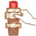
3. Visser manuellement l'écrou jusqu'à obtenir une certaine résistance de la bague.
