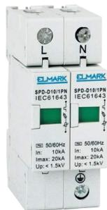
Le limiteur de surtension est composé d'un élément à valve de semi-conducteur (varistor) qui s'ouvre dans certaines conditions. Dans des conditions normales, le limiteur de surtension a une résistance infiniment haute entre les conducteurs protégés et le circuit de la terre. En cas d'augmentation de la tension provoquée par une cause atmosphérique ou une panne dans le système, l'élément à valve s'ouvre et conduit la surtension vers le circuit de la terre.
