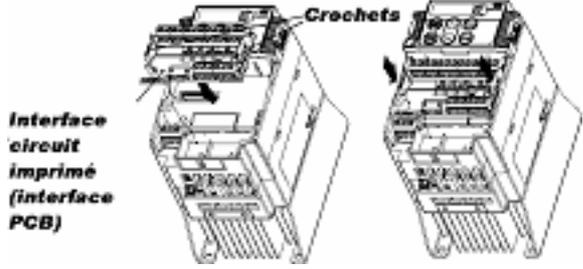
Figure 3.15 Montage du circuit imprimé d'interface (PCB d'interface)
