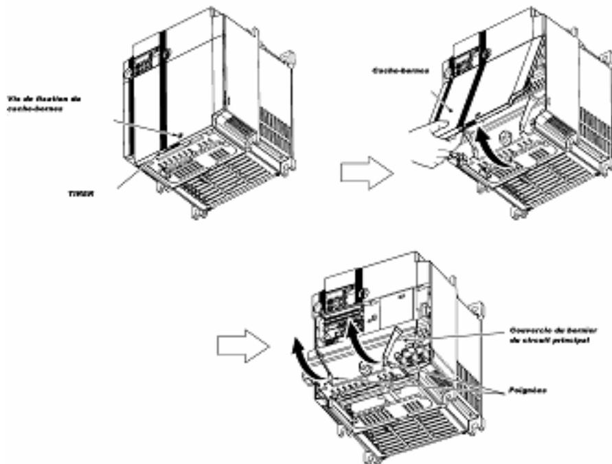
Figure 3.4 Retrait des couvercles (pour les variateurs ayant une capacité de 11kW et de 15kW)
