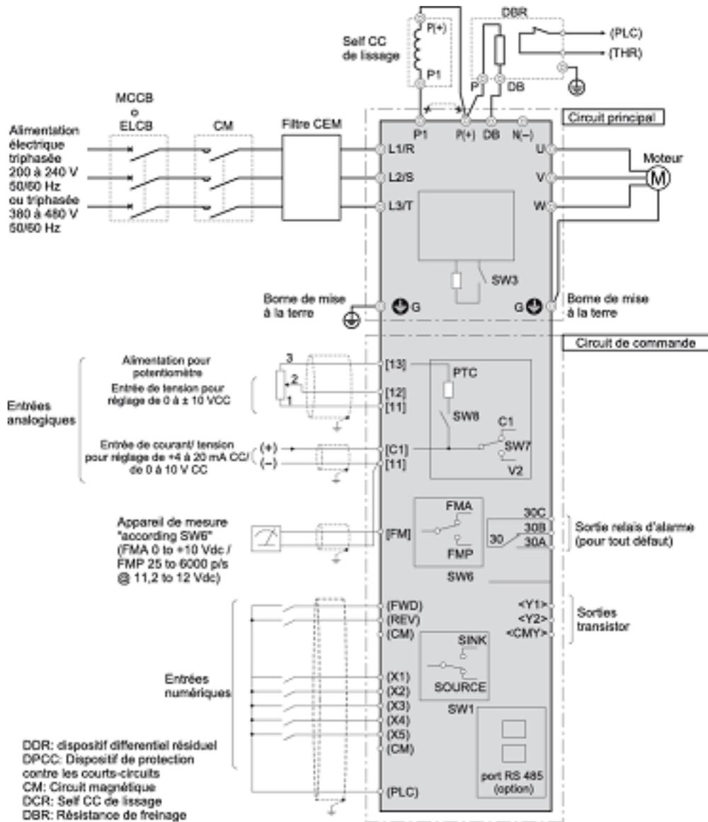
(Remarque 1) Lors de la connexion d'une inductance CC de lissage (DCR) en option, retirez le cavalier des bornes [P1] and [P(+)].
