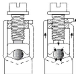
En serrant la vis on exerce une pression sur les deux parties de la cage de verrouillage ce qui engendre un blocage mécanique de la vis. Ce système est excellent contre les vibrations
