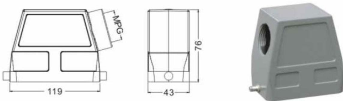
Prise à embase à fixer sur armoire : CMB\_32\_Px\_DH\_010
