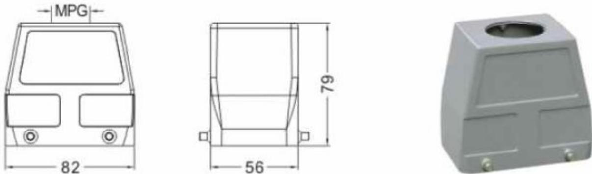
**Prise à embase à fixer sur armoire : CMB\_32\_Px\_D\_010**
