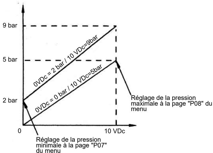
Aux pages "P07" et "P08" du menu, vous pouvez configurer respectivement la pression minimale et la pression maximale de sortie du régulateur qui correspondent aux valeurs minimales et maximales du signal de commande.
