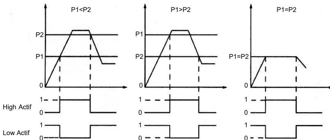
Ce type de signal de sortie alimente le PIN4 avec une tension de 24VDC en fonction des pressions "HIGH" ou "LOW" configurées.
