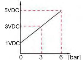
Par exemple, si le régulateur a un signal de feedback 1-5VDC avec un réglage de la pression minimale à 2 bar et de la pression maximale à 7 bar, nous obtenons:
