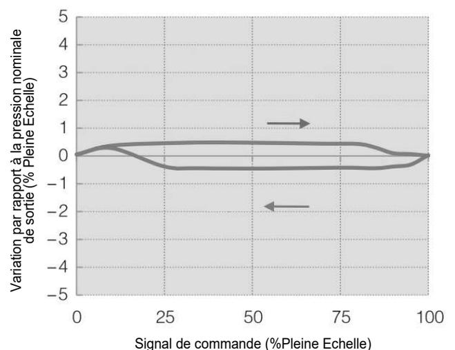
Valeur exprimée en pourcentage de la pleine échelle qui définit la variation maximale obtenue sur la pression avec un signal de commande identique. Cet écart est dû à la friction des composants mécaniques du régulateur qui se comportent différemment selon que la pression augmente ou diminue.
