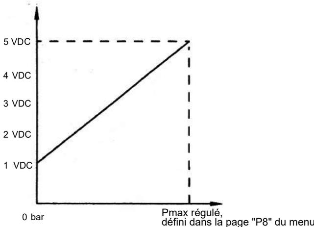
Par exemple, si le régulateur a un signal de feedback 1-5VDC avec un réglage de la pression minimale à 0 bar et de la pression maximale à 6 bar, nous obtenons:
