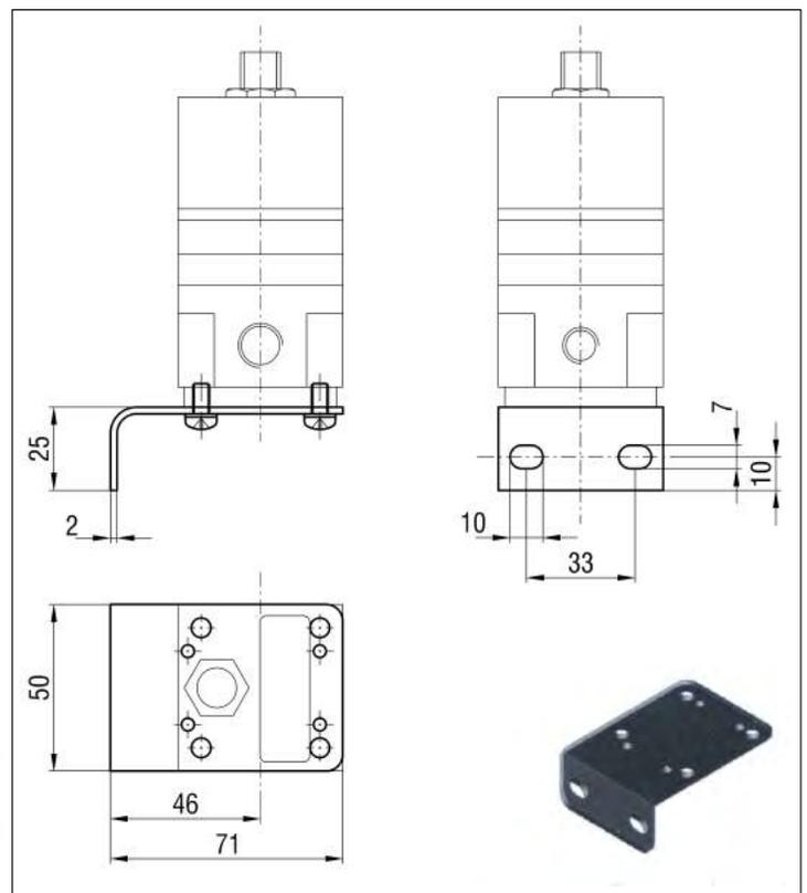
Vis pour la fixation du régulateur sur le support incluses
