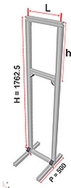
Châssis en profilé aluminium de type 2
