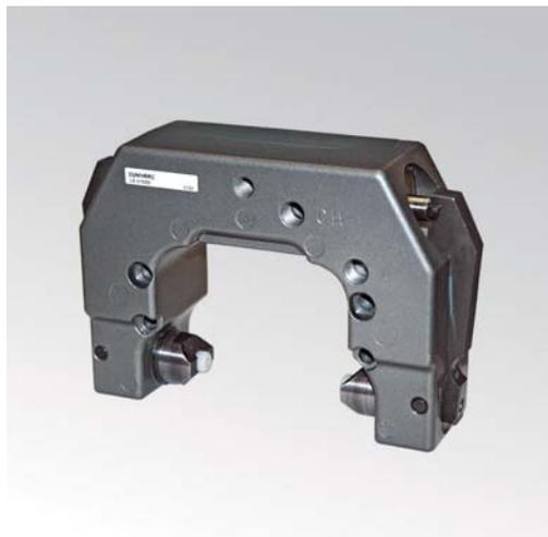
Les bloqueurs UNIVER pour vérins sans tige ont la fonction de garder le chariot dans le point de course choisi et permettent une grande précision de blocage. On peut les monter sur les deux côtés du chariot et leur force mécanique de freinage peut être encore augmentée par une commande pneumatique supplémentaire.
