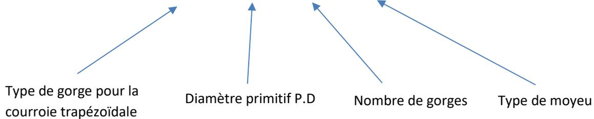
*Forme de la courroie pour déterminer le type de poulie*
