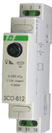
L'éclairage est allumé par une impulsion de courant envoyée après avoir appuyé sur un bouton poussoir relié au relais. Une autre impulsion éteint l'éclairage. Appuyez et maintenez l'interrupteur pendant plus de 1 seconde permet à l'utilisateur de régler l'intensité lumineuse (ajustements de boucle dans l'ordre suivant: BRILLANT→FONCE→BRILLANT).
