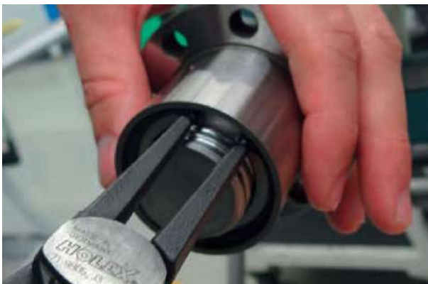
Fig. 4.9 : retrait du circlip
