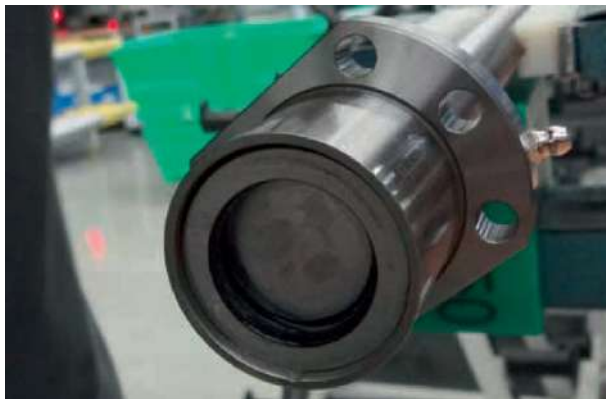
Fig. 4.10 : retrait de l'anneau en tôle
