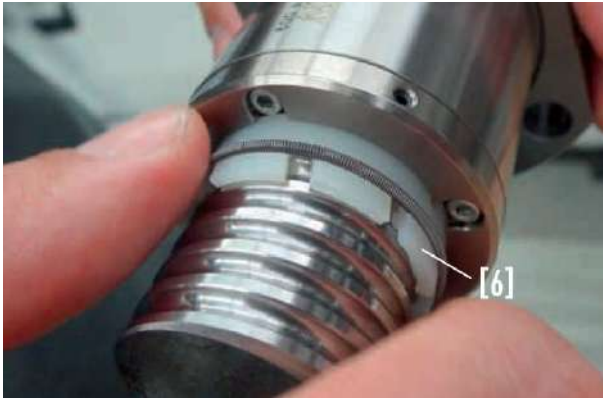
Fig. 4.15 : retrait du déflecteur à doigts
