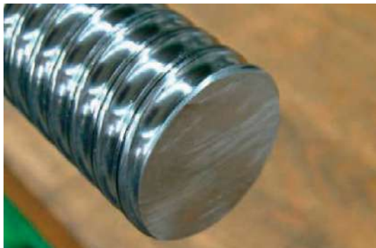
Fig. 4.3 : fin de la vis avant le montage du déflecteur NBR
