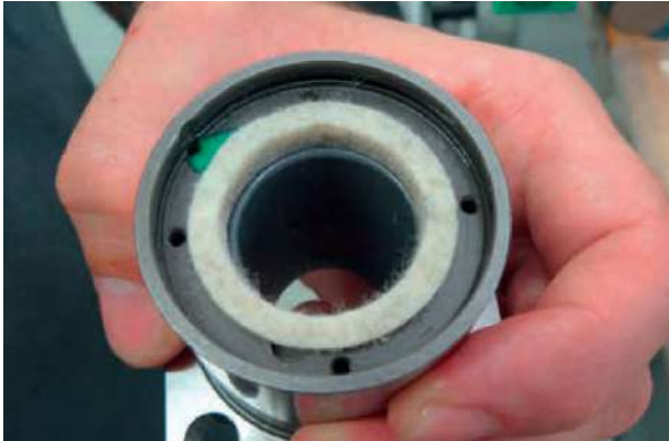
Fig. 4.13 : écrou avec déflecteur en feutre en place
