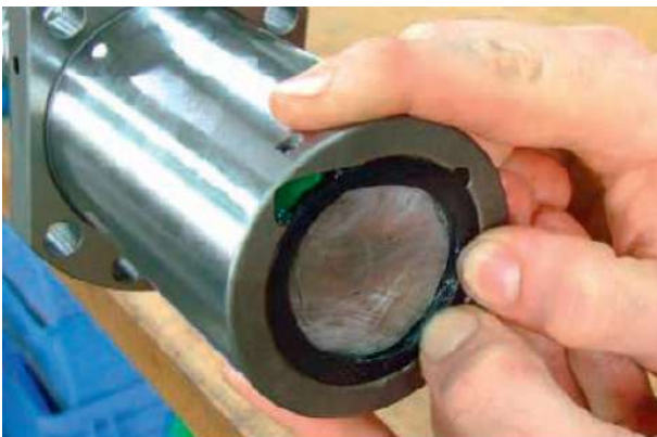
Fig. 4.7 : fixation du déflecteur pendant le vissage lent de l'écrou sur la vis
