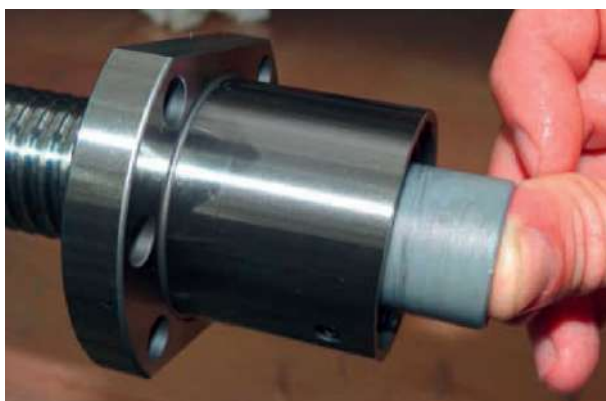
Fig. 4.11 : démontage de l'écrou à l'aide d'une douille de montage
