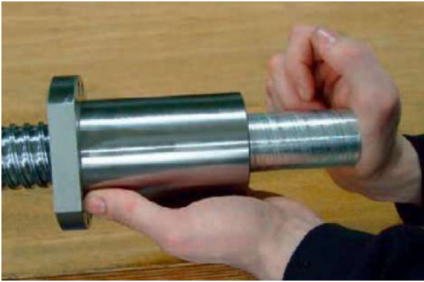
Fig. 4.6 : vissage de l'écrou avec le déflecteur sur la vis
